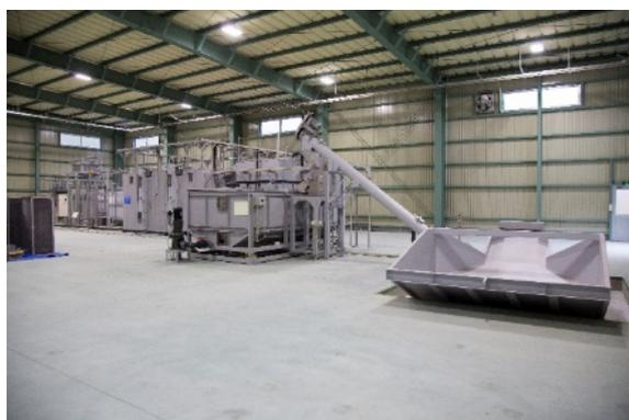
図 2 大型バイオガス装置(Large Biogas Generator)
